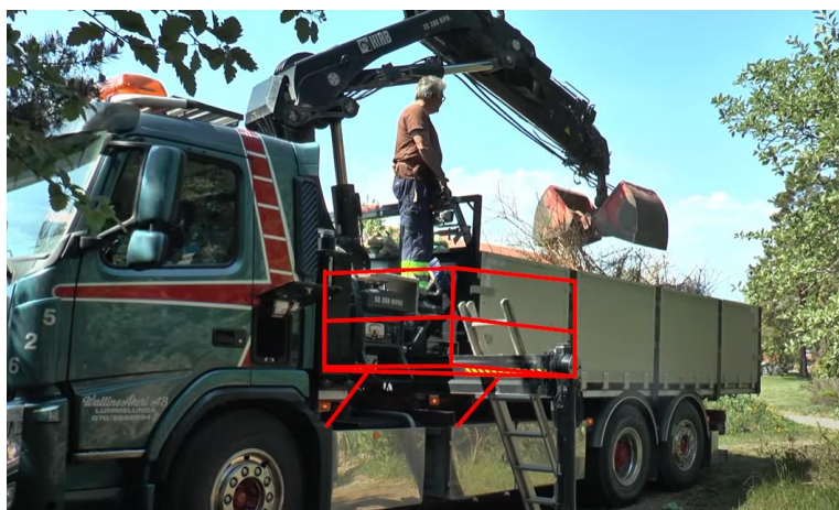
Figur 4-3 Utfällbara plattformar för personal. Bör vara utformade så att man enkelt kan ta sig till flaket utan att klättra.
